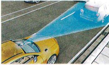
In Lindau werden u.a. Sensoren entwickelt, mit deren Hilfe z.B. der vorausschauende Notbremsassistent (Bild links) funktioniert. Dieser bremsst automatisch, wenn der Fahrer nicht angemessen reagiert. BZ-Foto: Continental
